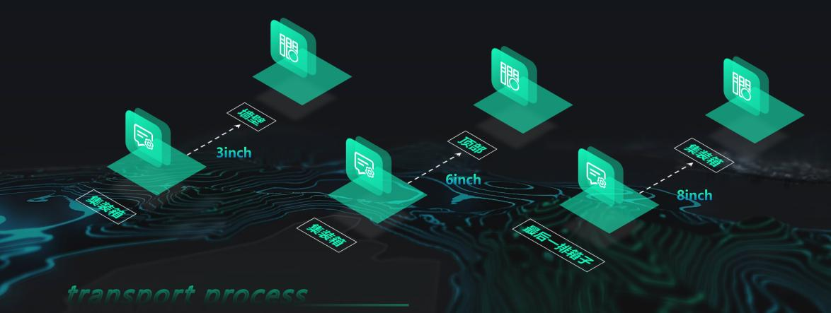
运输过程中集装箱堆叠和墙壁之间至少保持3inch的距离,顶部要留有6inch的空间,这是为了叉车能安全的卸载托盘, 同时最后一排箱子与集装箱门之间至少要留出8inch的间隙,以允许dock调整板进入。
