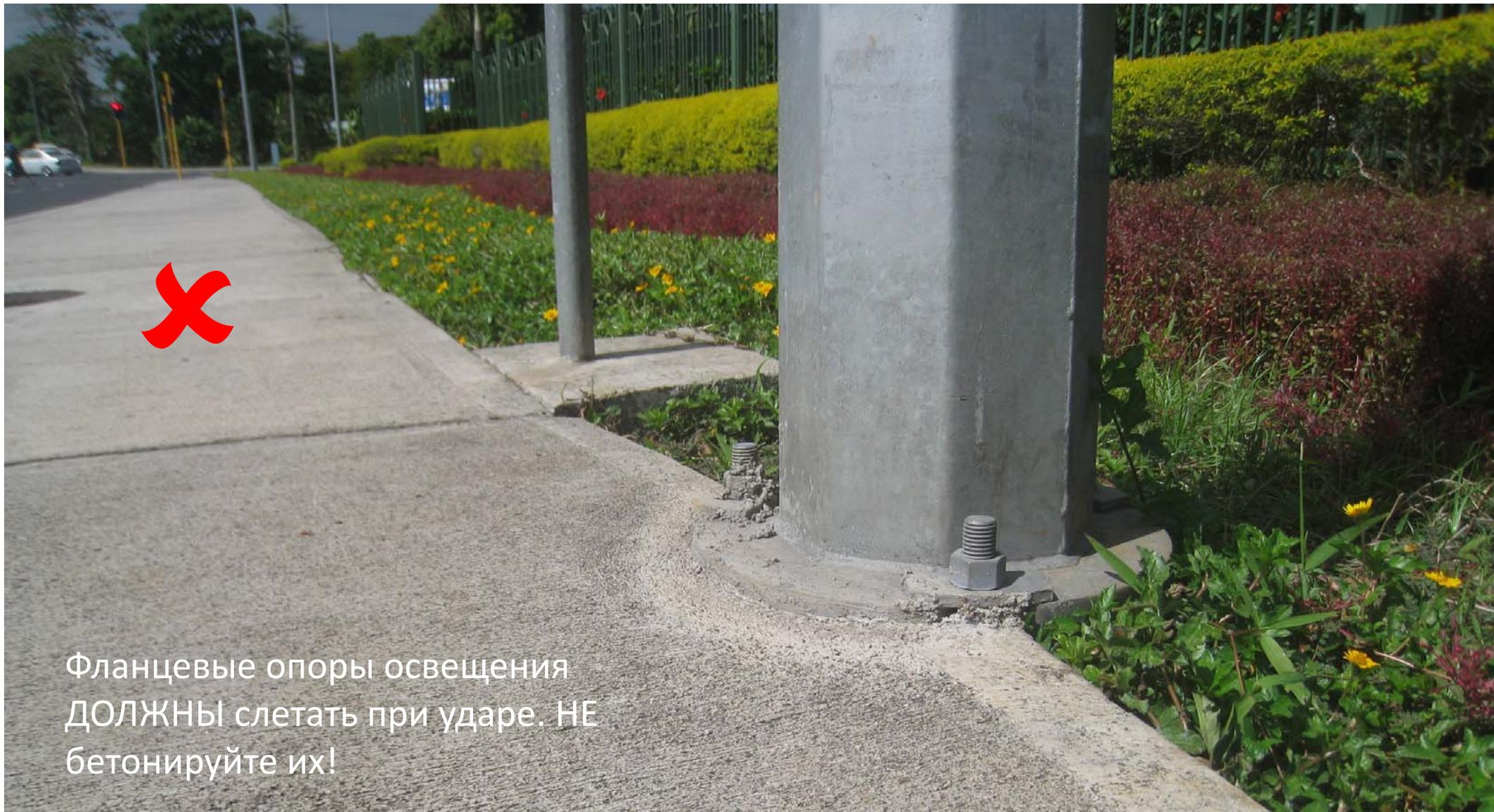
Фланцевые опоры освещения
