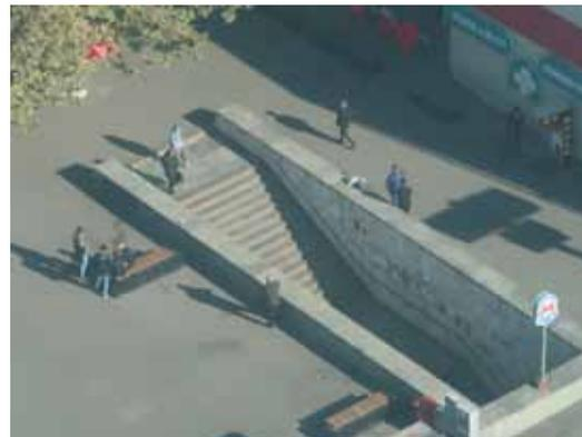
**Подземные переходы.** Подземные переходы часто проектируются с учетом архитектурных целей, а не безопасности дорожного движения и личной безопасности. Расположение подземного перехода и ориентация подходов являются важными факторами, определяющими его возможное использование. Лучшие подземные переходы предназначены для использования людьми с ограниченными возможностями, имеют хорошее освещение и предлагают посетителям ощущение открытости и уюта.
