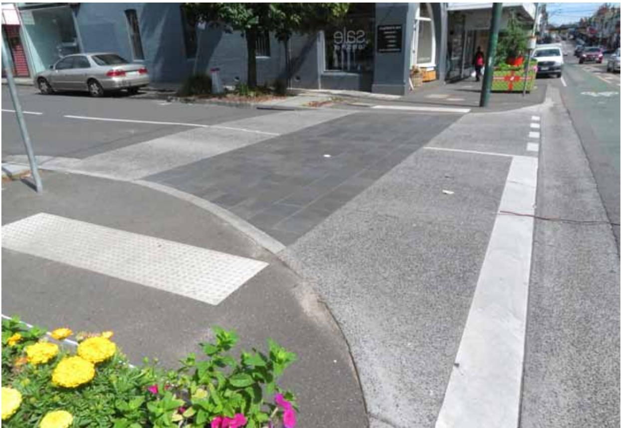
**Снижение скорости в конфликтной зоне.** Дорожный порог может выглядеть привлекательно, обеспечивать четкий и строго обозначенный вход на местную территорию и предлагать некоторые практические преимущества для пешеходов. Разметка «зебры» может быть установлена поперек «хампа» над проезжей частью, если национальные стандарты или правила дорожного движения требуют наличия такой разметки на перекрестках.
