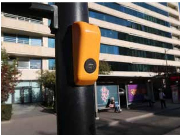
**Аудио-тактильные кнопки для пешеходов.** Наиболее полезные устройства обнаружения пешеходов имеют большую кнопку для удобства использования, звуковой сигнал для помощи слабовидящим и тактильный блок для помощи людям с нарушениями зрения или слуха. Ориентация тактильной стрелки указывает слабовидящим в сторону перехода. Центр стрелки медленно пульсирует до начала пешеходного интервала, после чего скорость пульсации начинает увеличиваться по мере усиления звука.
