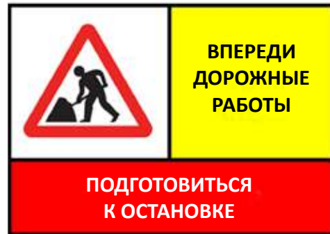
Рисунок 5: Часто используемый комбинированный знак для зоны предварительного предупреждения
