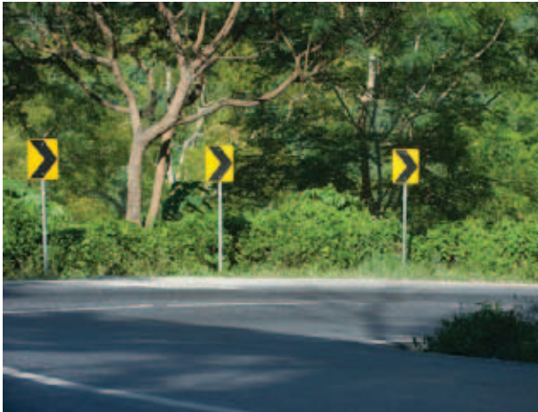
Было доказано, что шевронные указатели помогают водителям безопасно проходить кривые малого радиуса. Рекомендуется единообразно использовать их по всей сети автодорог ЦАРЭС.
