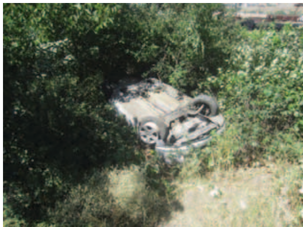
Крутой боковой откос (с уклоном более 1V:3H) увеличивает риск ДТП с опрокидыванием. В свою очередь, это увеличивает риск серьезных травм или смерти тех, кто находится в автомобиле.
